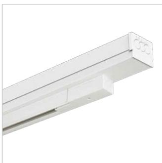
Rail à 6 conducteurs (plus la terre) Eurostandard Plus (L1/L2/L3/N/GRD/DA/DA) 16A/440V avec embout d'alimentation et bouchon de fermeture.
