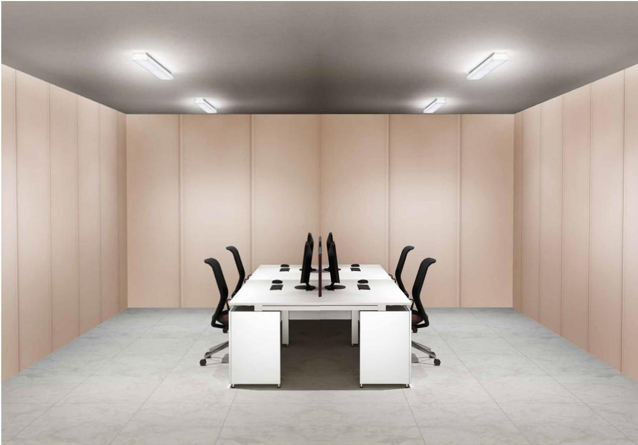
La composante de lumière indirecte réduit le contraste visuel et donne l'impression que le produit est suspendu, bien qu'il soit monté au plafond; le mélange avec les rayons lumineux directs génère un **éclairage uniforme**, jusqu'à l'angle situé entre les murs et le plafond.
