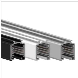
Binaire en aluminium extrudé avec 6 conducteurs en cuivre (L1/L2/L3/N/GRD/DA/DA) 16A/440V.
