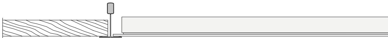
Panneaux en fibre minérale avec ossature apparente 600x600 ou 625x625.
