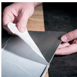
Possibilité d'appliquer des films adhésifs pour couvrir les surfaces des panneaux Backlight; ces films sont fournis par le client ou peuvent être fournis par Braco S.r.l.
